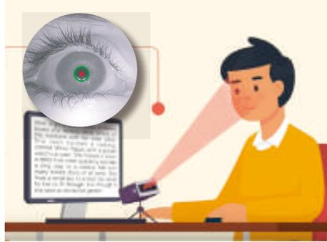
시선추적(Eye tracking)은 눈동자의 움직임을 측정함으로써 시선의 위치와 속도, 방향 등을 분석하는 기술입니다.
